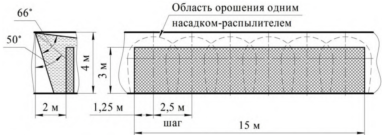
Рисунок 16 - Противопожарная защита боковой поверхности стеллажа 6-ю насадками-распылителями
